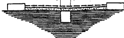
图 G2 触头支持用固定的和移动的绝缘件间的爬电距离
